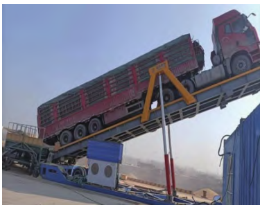
图2 马铃薯大型液压装卸平台
