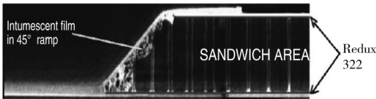
图 3 45°封边框蜂窝芯子夹层结构示意图
