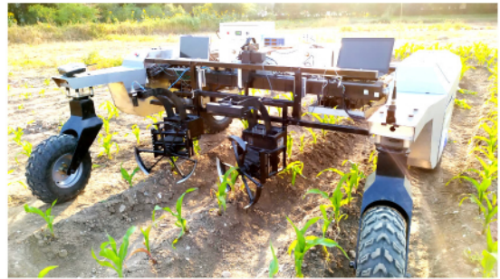
图6 智能株间除草装置的田间试验照片
