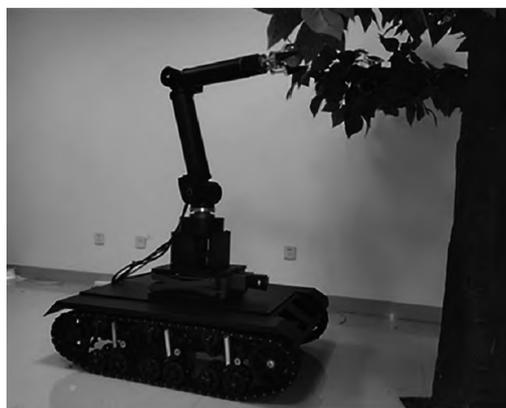
图 8 苹果采摘机器人样机图
