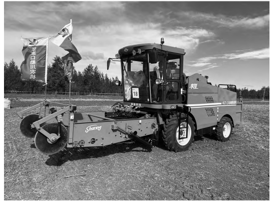
图7 享锐 4UZ-2J 马铃薯捡拾机 Fig.7 XIANGRUI 4UZ-2J potato picker
