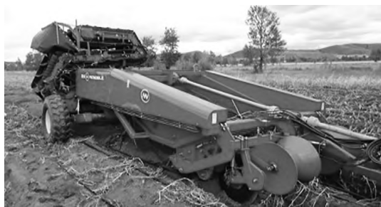
图3 中机美诺1710型马铃薯联合收获机
