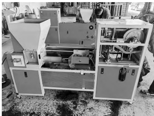
图 6 电动菌包一体机作业现场
