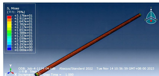
图 4 拉伸应力云图
