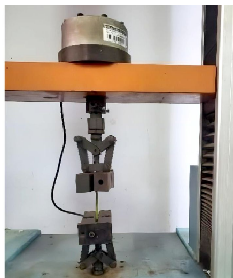
图 2 拉伸试验设备
