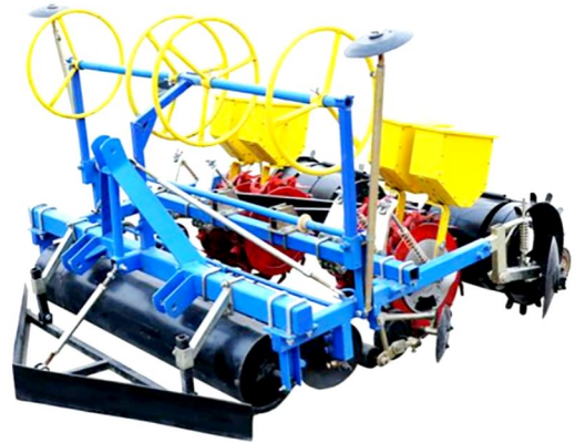
图8 天诚2MBJ型播种机 Fig. 8 Tiancheng 2MBJ planter
