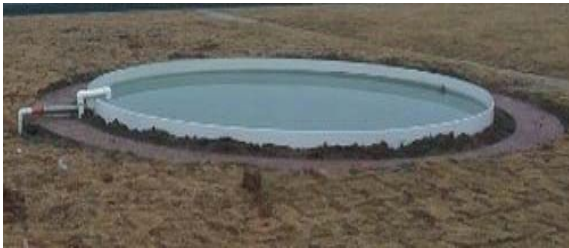
图 1 试验用 20 m 2 蒸发池 Fig.1 Evaporation pool of 20 m 2 for test
