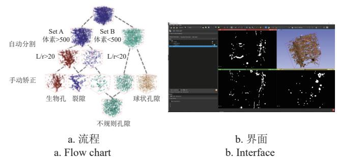
图 2 土壤孔隙标定流程和 3D Slicer 标定界面演示图
