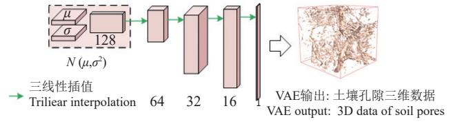
图 5 变分自动编码器生成网络解码器结构
