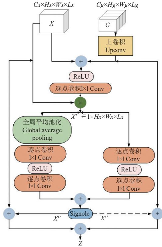
图 5 多尺度融合注意力模块结构图
