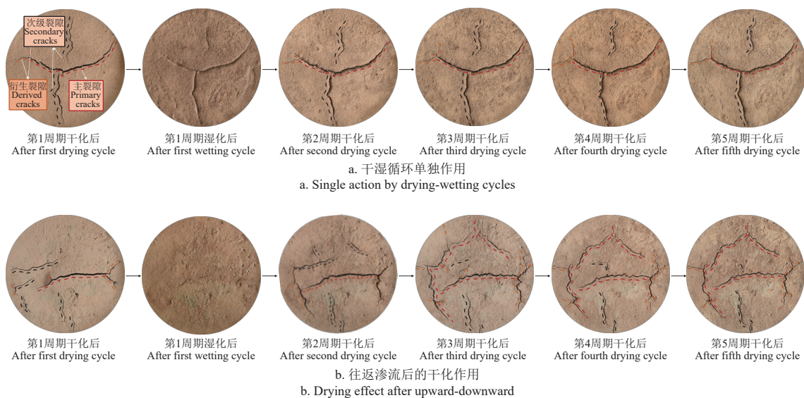
图 6 不同控制条件下裂隙演化过程
