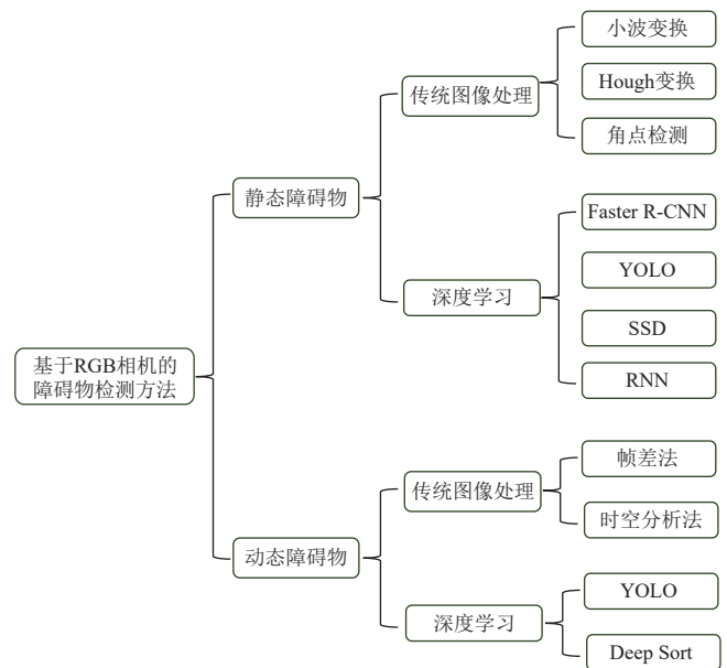
图 1 基于 RGB 相机的障碍物检测方法
