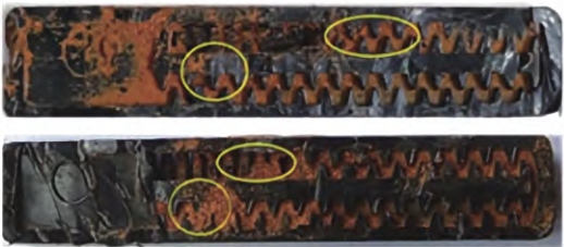
图 6 动态水压滴头的堵塞情况
