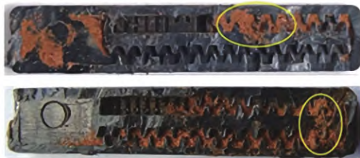
图 6 动态水压滴头的堵塞情况
