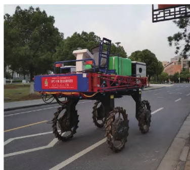
图12 硬质路面下喷雾机姿态控制场地试验
