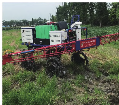
图14 田间泥泞环境下喷雾机姿态控制场地试验
