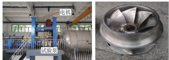
图5 叶轮与立式离心泵闭式试验台实物图
