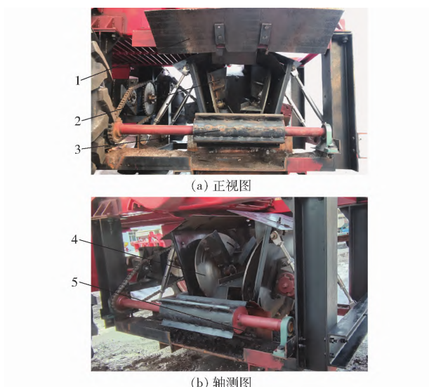
图 24 倾斜对置圆盘侧抛试验装置
