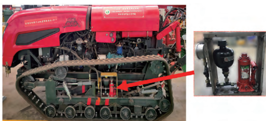
图 18 基于蓄能器的橡胶履带随动张紧装置
