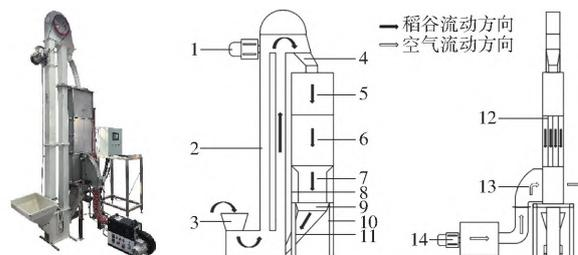
图1 干燥试验台实物图与工作原理图
