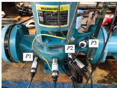
图 4 压力传感器安装位置
