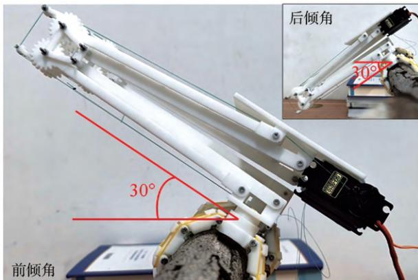
图16 机械臂倾斜试验
