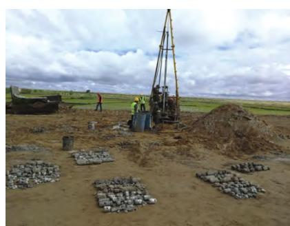
图1 试验钻机及试样
