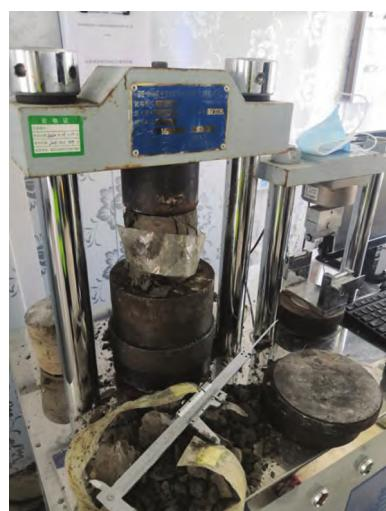
图2 无侧限抗压试验
