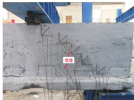
图 8 加固后空心板破坏照片
