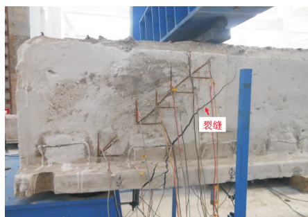
图 6 未加固空心板破坏照片
