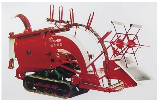
图1 湖州-100半喂入联合收割机 Fig. 1 Huzhou-100 Head-feed Harvester
