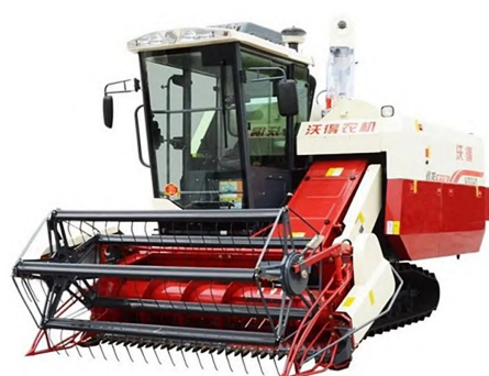
图4 纵轴流式收割机 Fig. 4 Longitudinal Axial Flow Combine Harvester
