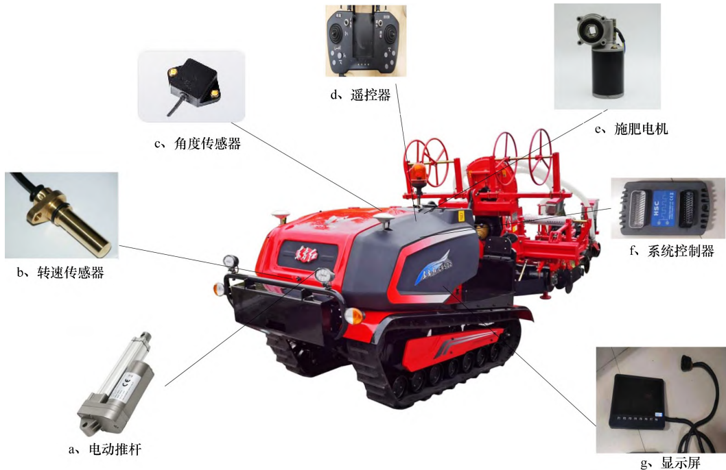
图 1 某型号辣椒机关键零部件标定控制系统组成示意图
