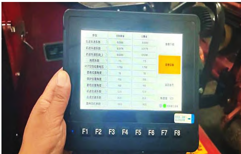
图 6 控制系统标定施肥参数示意图 Fig. 6 Schematic Diagram of Fertilizing Parameter Calibration of the Controlling System
