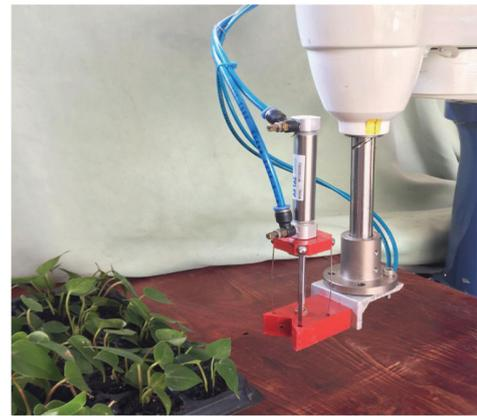
图7 移植手防苗损伤作业性能试验台
