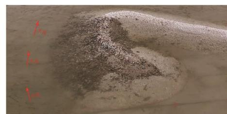
图12 工况1围堰裹头段试验流态
