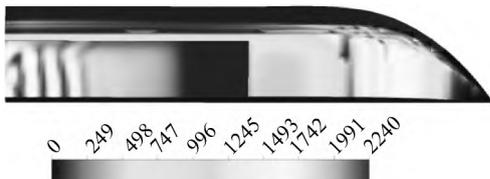
图 9 船底动态压力云图
